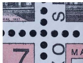
veľké perforačné otvory veľkosť PO 1,12; 1,18 mm
